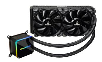
安耐美LIQTECH II系列,是一款适用于Intel® / AMD® 的CPU水冷散热器,专为高阶处理器而设计。凭借TDP 500W+的解热能力,可使 LIQTECH II即使在极端超频条件下也能提供卓越可靠的冷却性能。专利双腔体设计(专利号: CN202977401 U)可以将水泵与CPU热源隔开,进而提升水泵产品寿命;并且结合专利分流通道技术(专利号: CN202262208 U),冷水直冲铜底,可以直接将热分散从二边带走;进而提升水冷产品整体的散热效能。除此之外,LIQTECH II具备Addressable RGB导光圈水冷头,可支持新款addressable RGB主板同步提供亮丽的灯光效果。LIQTECH II是CPU超频主机、绘图工作站、服务器之优选。
